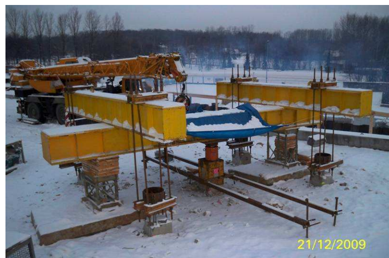
Próbné obciążenia pali
